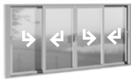
SK-06 Vier Schiebeelemente in zwei Schienen
